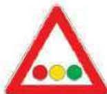
F.R 190 031 B semaforo con lanterne orizzontali
