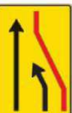
FCR 790411 A D segnalazione corsia chiusa (destra)
