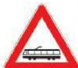
F.R 190 012 attraversamento ferroviario
