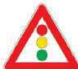
F.R 190 031 A semaforo con lanterne verticali
